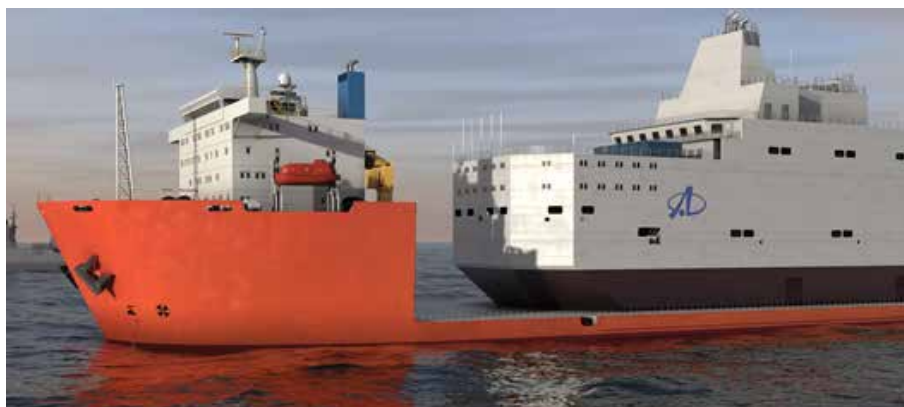
Рис. 3. Транспортировка ОПЭБ к месту базирования на судне-доке
