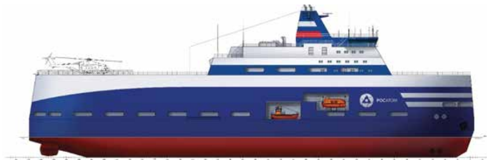
Рис. 4. Судно обеспечения электроэнергией пр. 24870: мощность, выдаваемая потребителям 100 МВт; Длина 140 м; Ширина 30,0 м; Осадка 7,0 м; Водоизмещение 24000 т.
