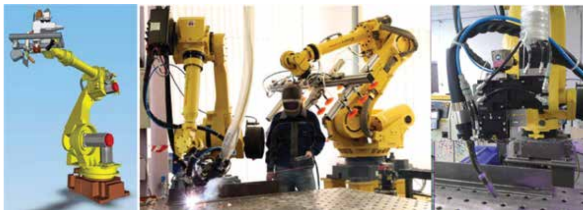
Рис. 2. Гибридная лазерно-дуговая установка на базе антропоморфного робота.
