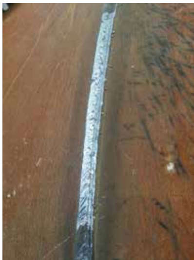
Рис. 5. Обратное формирование при корневом проходе. Орбитальная лазерно-дуговая сварка по зазору 2 мм при смещении кромок 3 мм.
