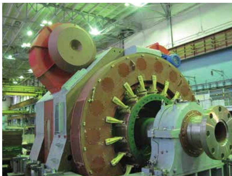
Рисунок 11 – Двигатель 2МП17600 мощностью 17,6 МВт на стенде завода «Электросила» АО «Силовые машины»
