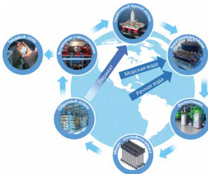
Рис. 1. Реализация технологии нулевого жидкого сброса, применительно к утилизации отработанных буровых растворов и опреснению морской или речной воды
