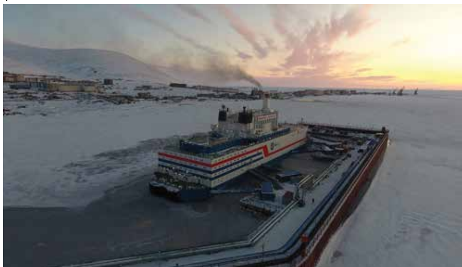
Рис. 1. ПЭБ «Академик Ломоносов» на месте базирования в г. Певек. Проект 20870: длина 144 м; ширина 30,0 м; осадка 5,9 м; водоизмещение - 22500 т.
