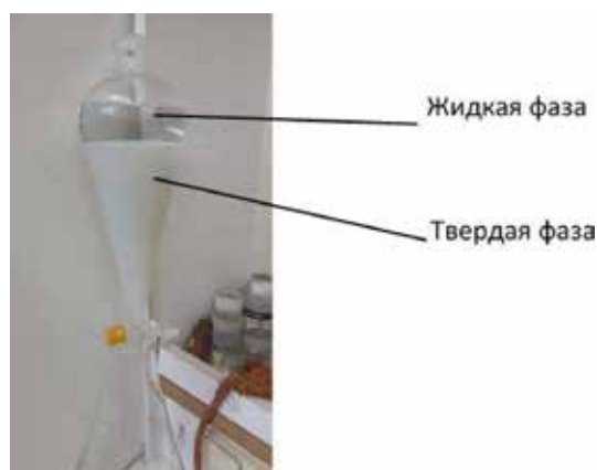
Рис. 3. Отработанный буровой раствор после электрокоагуляции. Материал электродов: Al-Al, расстояние между электродами 5 мм, плотность тока 24 мА/см 2 , продолжительность электрокоагуляции: 30 мин., продолжительность отстаивания: 3 часа
